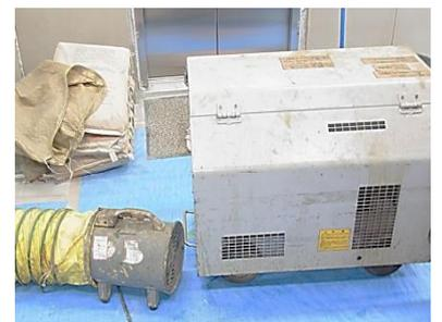
エンジンコンプレッサーは駆動時に空気を必要とするため、室外設置とします（現場から 100m の距離まで設置可能です。設置場所次第では、近隣様から室外設置承諾をお願いいたします）。
